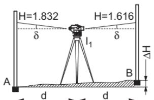
При расположении в центре и отрегулированном пузырьке круглого уровня, линия визирования должна быть горизонтальной.
