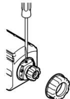
Когда разница между теоретическим и действительным показанием составляет больше 3 мм, линия визирования должна быть отрегулирована.
