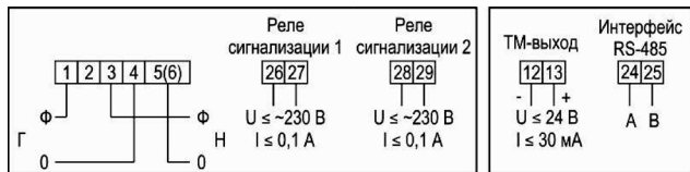
Рисунок В.16 – Схема включения счетчиков CE 102 тип корпуса R8, исполнения «AOKSSVZ»
