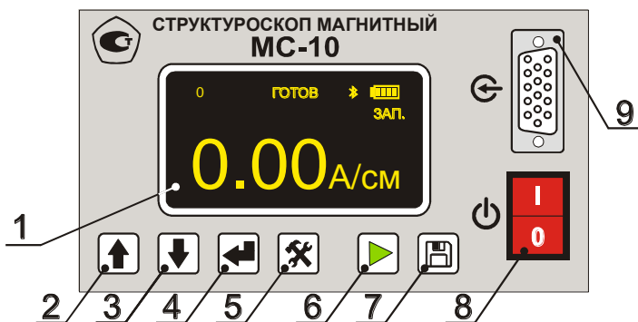
Рис.4 Органы управления структуроскопа магнитного MS-10
