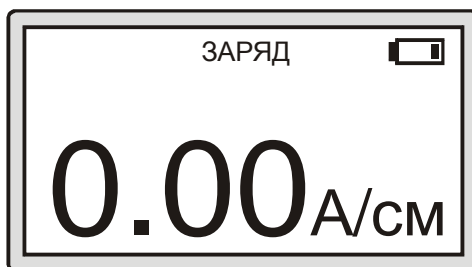
Рис.6 Рабочий экран структуроскопа во время зарядки АКБ
