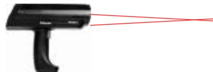
*Прицел с пересекающимися лучами:* Для точного измерения температуры маленьких объектов, выберите эту модель 3i. Минимальное измеряемое пятно пирометра – в точке пересечения двух лазерных лучей.
