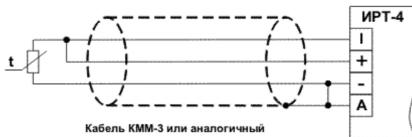
Рисунок 3 Трехпроводная схема подключения ТС
