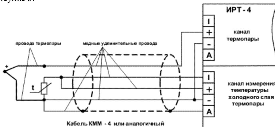
Рисунок 5 Подключение термопары с помощью удлинительных проводов
