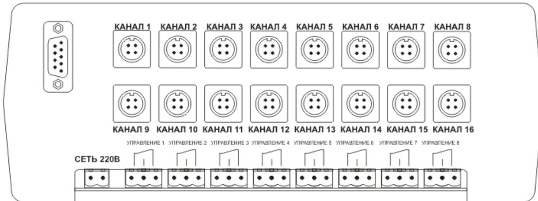
Рисунок 19 Исполнение “Измеритель – регулятор с выходными реле”
