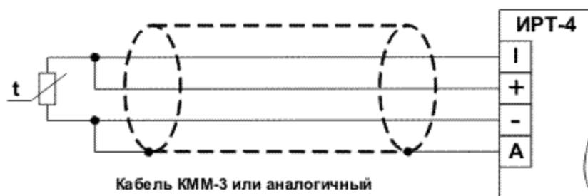
Рисунок 2 Четырехпроводная схема
