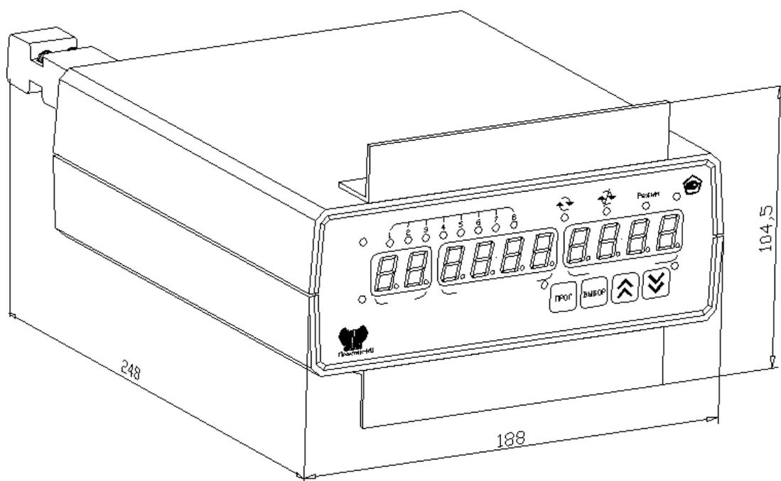
Габаритные размеры прибора
