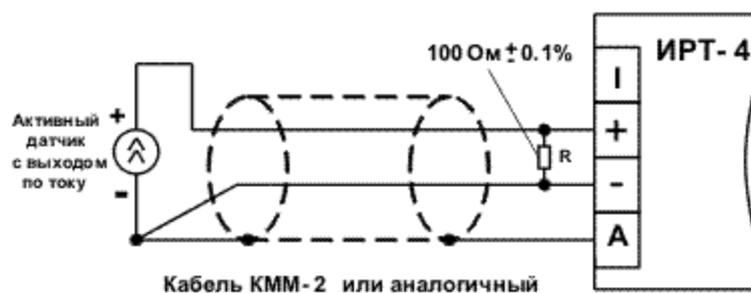
Рисунок 8 Подключение активного датчика с унифицированным токовым выходом
