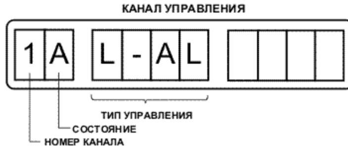
Рисунок 28 Канал управления при контроле состояния объекта
