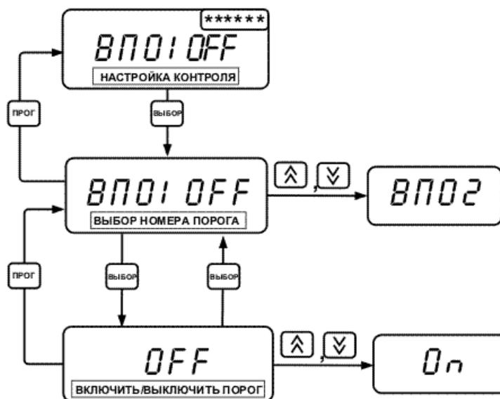
Рисунок 42 Настройка контроля по верхним порогам
