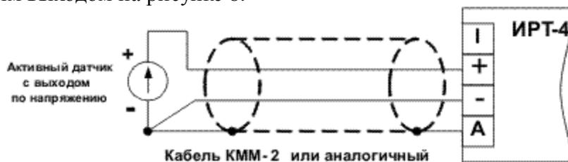
Рисунок 7 Подключение активного датчика с выходом по напряжению
