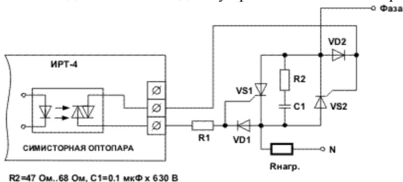
Рисунок 16 Подключение выходных устройств с использованием силовых тиристоров
