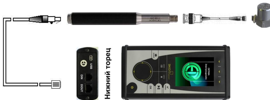
Рис.2. Подключение ОКТАФОН-110В с датчиком АР37 к ИБ ЭКОФИЗИКА-D
