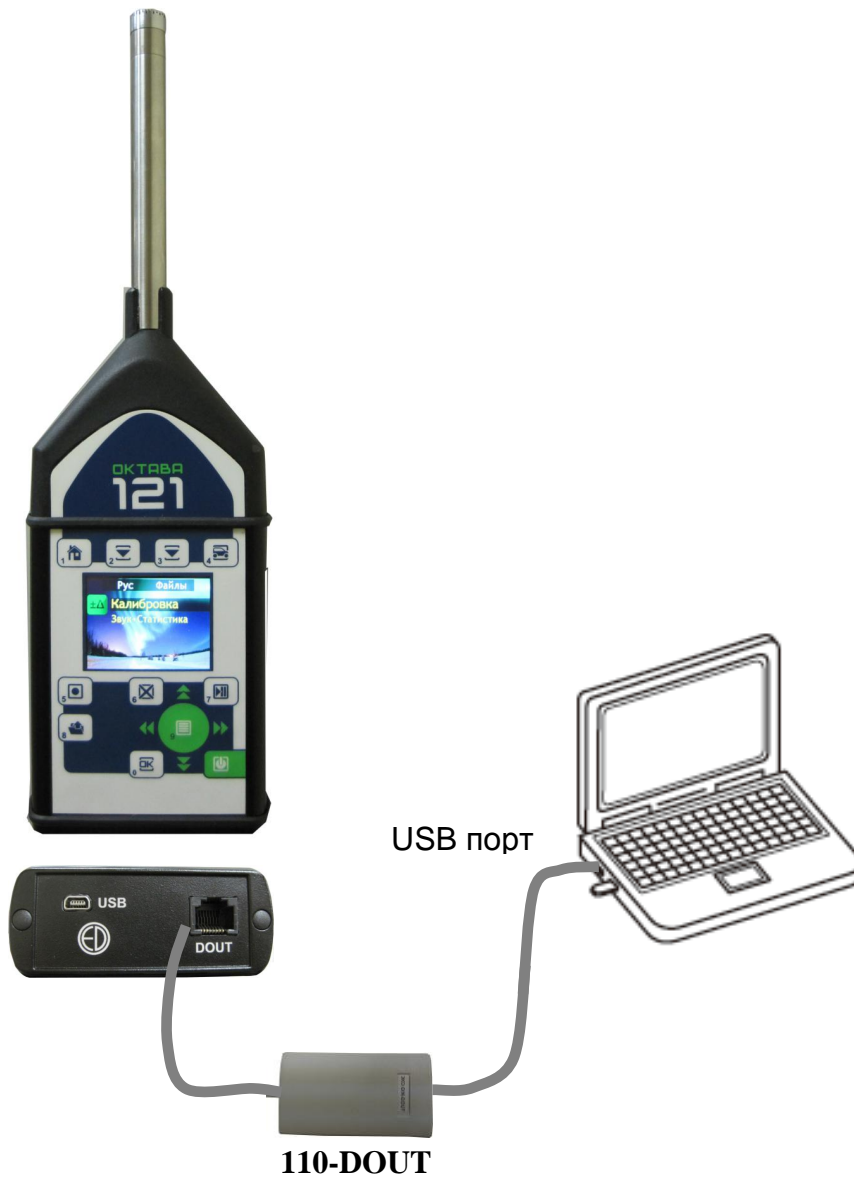
Схема 4. Подключение прибора к компьютеру для передачи телеметрии данных в режиме реального времени
