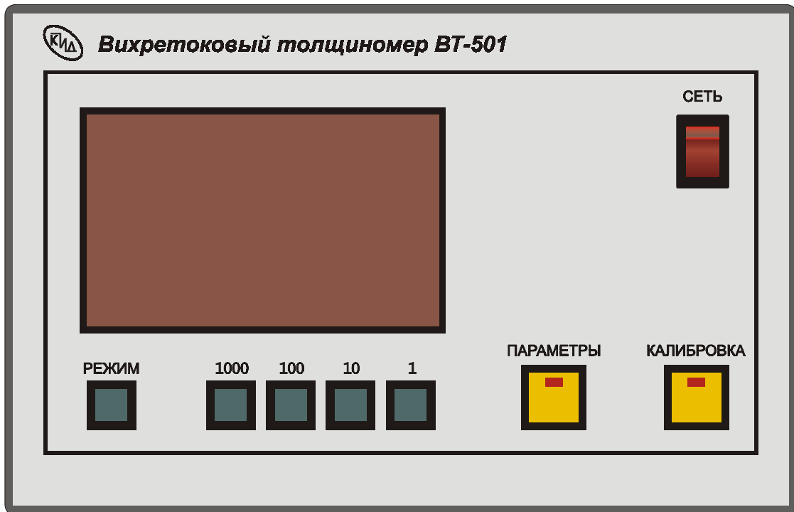
Рис. 1 Передняя панель электронного блока толщиномера
