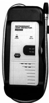
RD99 представляет собой детектор утечек охлаждающих газов, разработанный на основе передовых технологий. Этот детектор может обнаруживать любые из существующих галогенсодержащих газов, используемых в качестве хладоагентов. К этим газам относятся хлорфторуглероды (CFC), гидрохлорфтор-углероды (HCFC), гидрофторуглероды (HFC) и другие галогенсодержащие вещества, такие как гексафторид серы (SF<sub>6</sub>), перхлорэтилен (C<sub>2</sub>Cl<sub>4</sub>) и галон.
