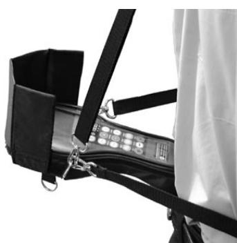
*Рис. 2.4 Крепление прибора на пояссе.*
