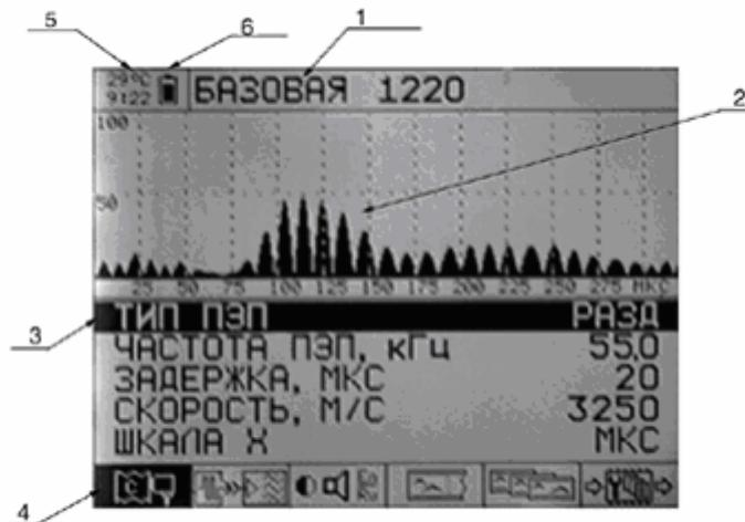
*Рис. 3.3 Экран прибора в режиме МЕНЮ (1 – название конфигурации; 2 – область представления осцилограмм; 3 – редактируемый пункт меню; 4 – выбранный раздел меню; 5 - температура внутри прибора; 6 – индикатор уровня заряда)*
