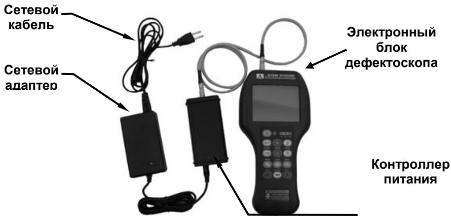
*Рис. 5.2 Соединение электронного блока прибора с блоками ЗПУ.*
