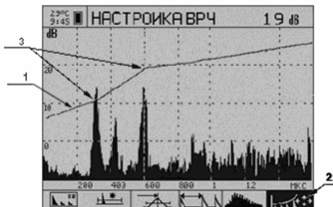
*Рис. 3.5 Экран прибора при настройке ВРЧ.
