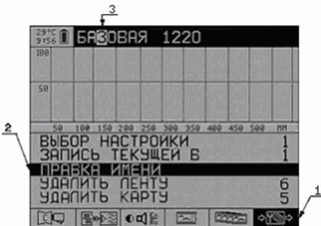
*Рис. 4.5 Экран в режиме МЕНЮ. Редактирование названия конфигурации*
