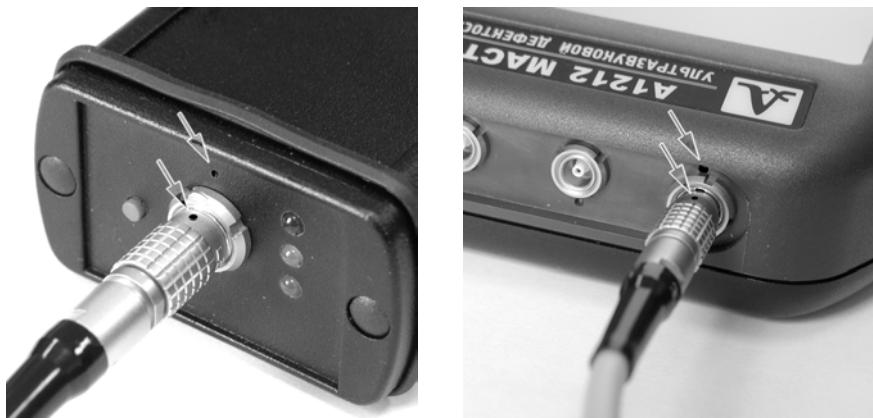
*Рис. 5.1 Ориентация разъемов при подключении зарядно-питающего устройства*
