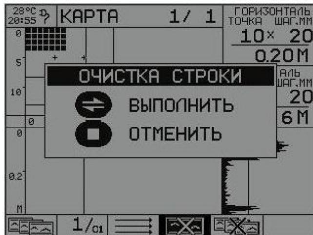
**Рис. 3.9 Экран прибора в режиме КАРТА при включенной пиктограмме очистка строки**
