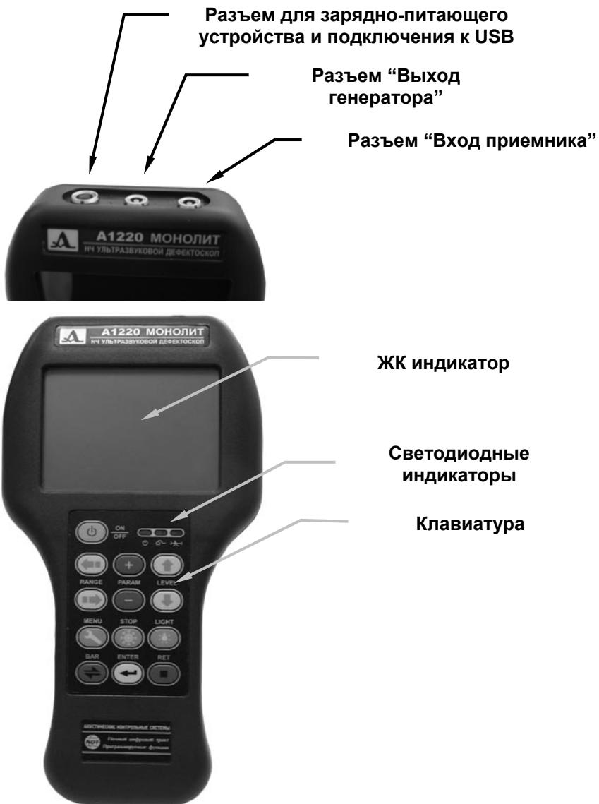
Рис. 2.1. Электронный блок дефектоскопа
