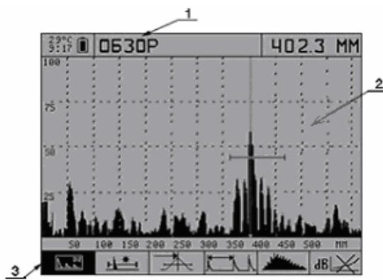
*Рис. 3.1 Представление информации на экране прибора (1 – название режима; 2 – область отображения сигнала; 3 – область пиктограмм )*
