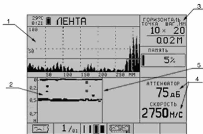
*Рис. 3.7 Экран прибора в режиме ЛЕНТА
