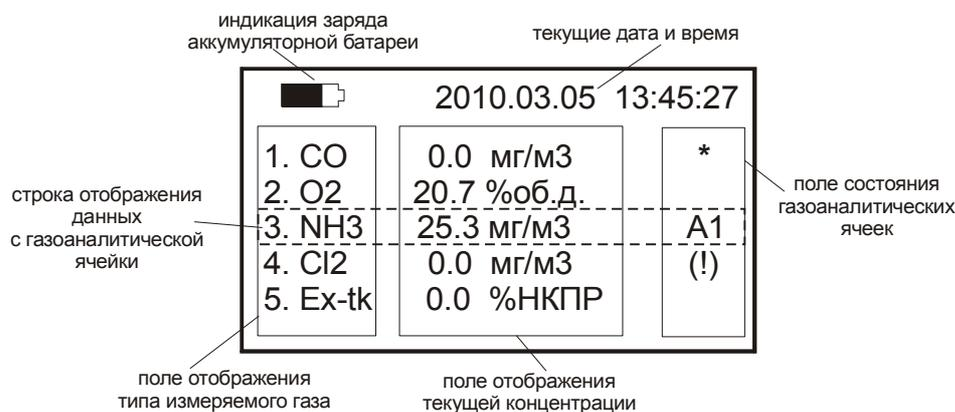
Рисунок 2.1. Вид дисплея газоанализатора в рабочем
