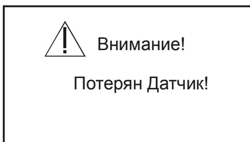
Рисунок 2.11. Вид дисплея газоанализатора при удалении ИСМ
