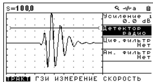
Рис.2-6 Радиочастотный сигнал
