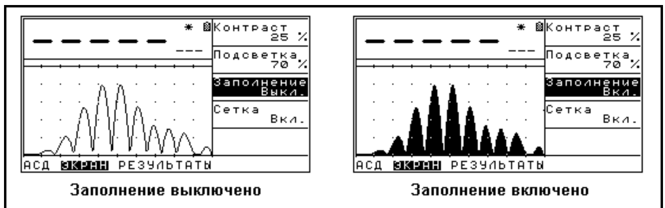
Рис.3.1. Иллюстрация действия параметра "Заполнение".
