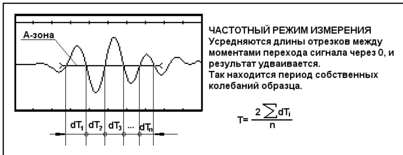
Рис.3.3. Иллюстрация принципа действия частотного режима измерения времени в А-зоне.
