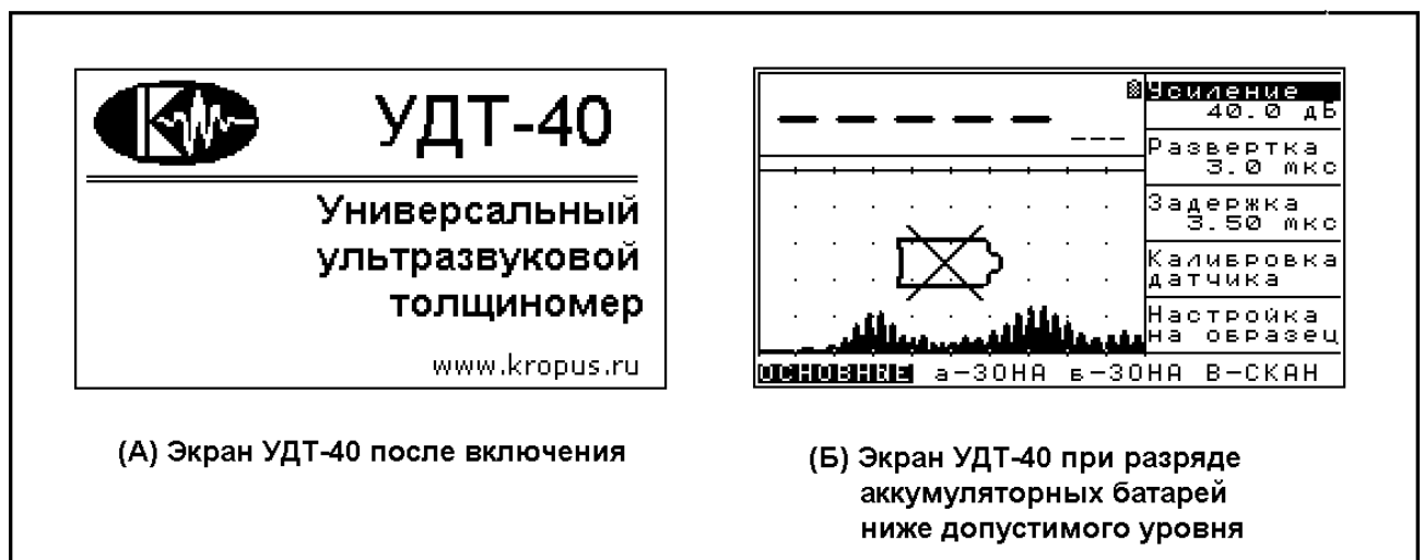
Рис. 1.3. Заставка прибора и экран при разряде батарей.
