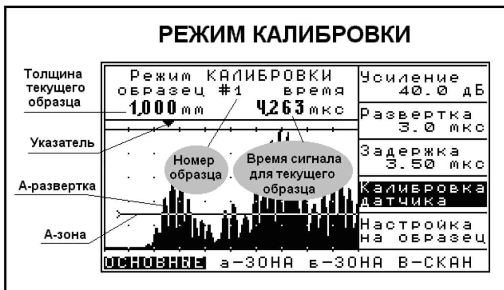
Рис. 3.7. Вид экрана УДТ-40 в режиме калибровки.
