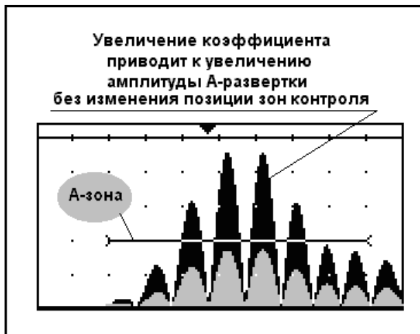
Рис.3.8. Иллюстрация эффекта от изменения коэффициента усиления.
