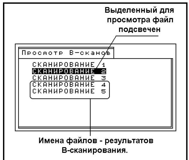
Рис. 4.13. Вид экрана УДТ-40 в режиме выбора файла для просмотра.
