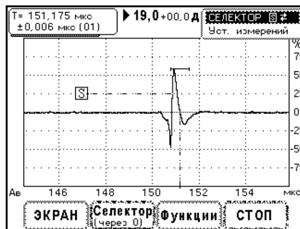
Рис.10.6.11.2. Вид заднего фронта маркерного импульса на экране прибора.
