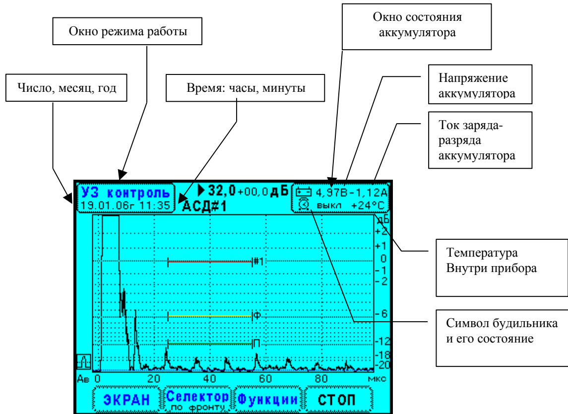
Рис.5.2. Внешний вид экрана дефектоскопа УД9812. Окно режима работы и окно состояния аккумулятора.
