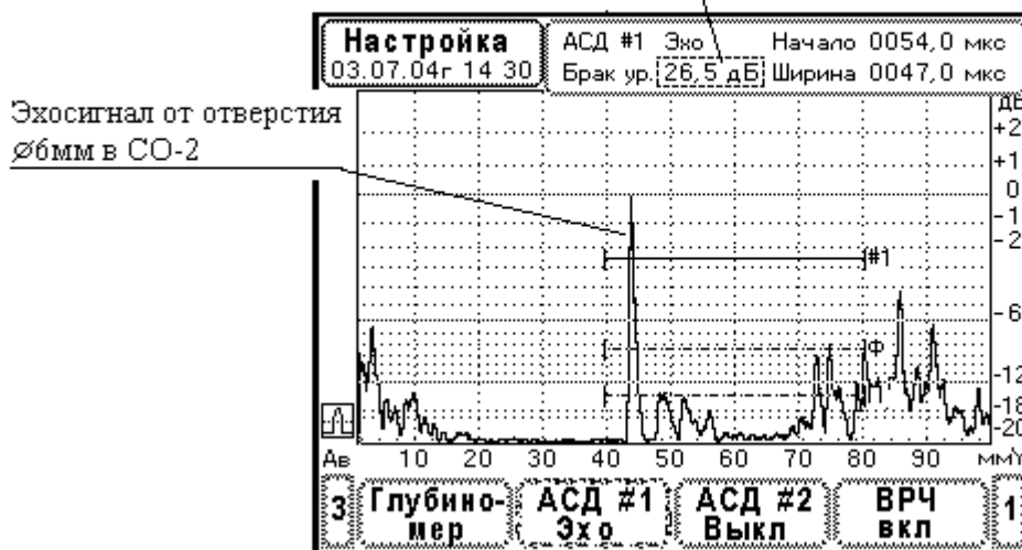
Рис. 9.4.15.3. Установка браковочного уровня АСД#1.
