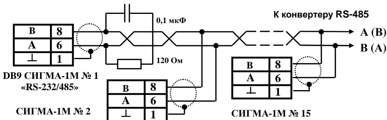
Рис. 5. Подключение газоанализаторов "СИГМА-1М" к сети RS-485.
