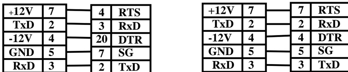
Рис. 4. Подключение газоанализаторов "СИГМА-1М" к ПЭВМ (RS-232).
