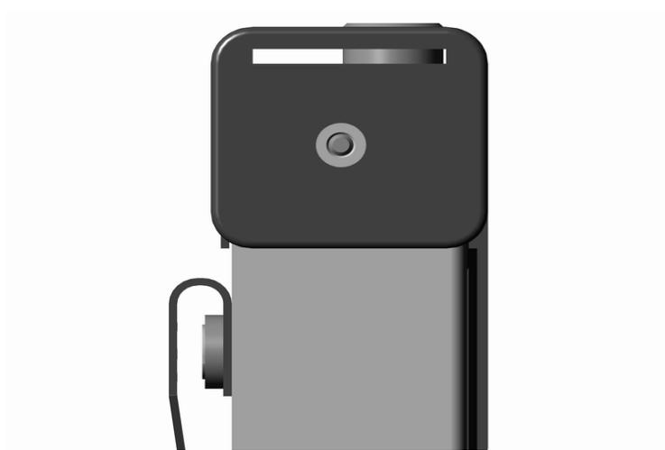
Рис.4. Расположение гайки, закрывающей доступ к регулировочному потенциометру
