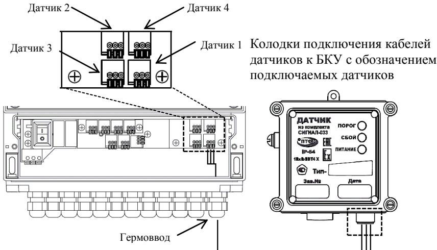
Внешний вид отделения коммутации сигнализатора со снятой защитной крышкой (штрихпунктирной линией выделено выделена колодка подключения кабелей датчиков)
