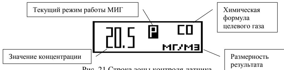
Рис. 21 Стока зоны контроля датчика
