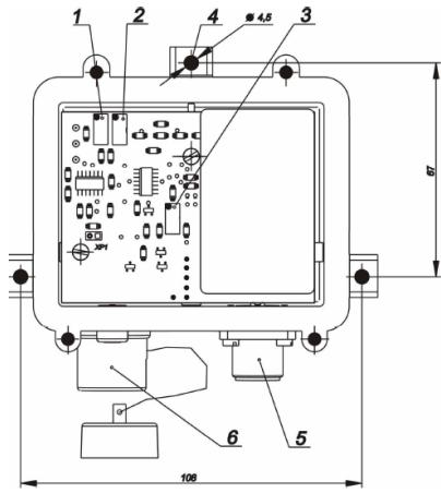
**Датчики МИГ-ТК со снятой
