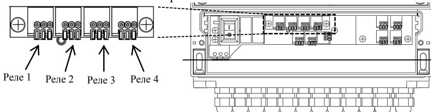
Колодка подключения кабеля внешних исполнительных устройств к сухим контактам реле 1...Реле 4
