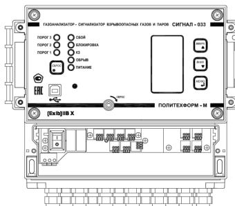
Рис. 1 БКУ с ЖК индикатором со снятой защитной крышкой с отделения
