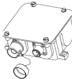
Рис. 5 Датчик МИГ-ТК в силуминовом корпусе
