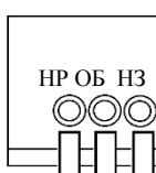
Рис. 14 Колодка подключеная к сухим контактам реле с обозначениями клемм
