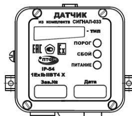
Рис. 3 Датчик МИГ-ЭЛ, МИГ-ОП в силуминовом корпусе
