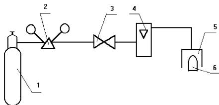
Рис. 1 Схема установки для подачи ГСО-ПГС на датчики
