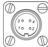
Колодка подключения кабеля датчика на БКУ с обозначениями клемм
