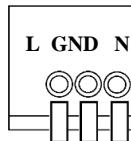
Рис. 12 Колодка подключения кабеля электропитания к БКУ с обозначениями клемм
