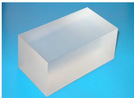
Рис. 3.2. Внешний вид рабочей эквивалентной меры прочности из оргстекла
