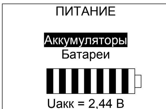
При продаже прибор комплектуется аккумуляторами и при их разряде до 2,0 В прибор автоматически выключается. При напряжении, близком к 2,0 В вместо секунд показаний часов прибор выводит измеренное значение напряжения источника питания, например «U=2.12».
