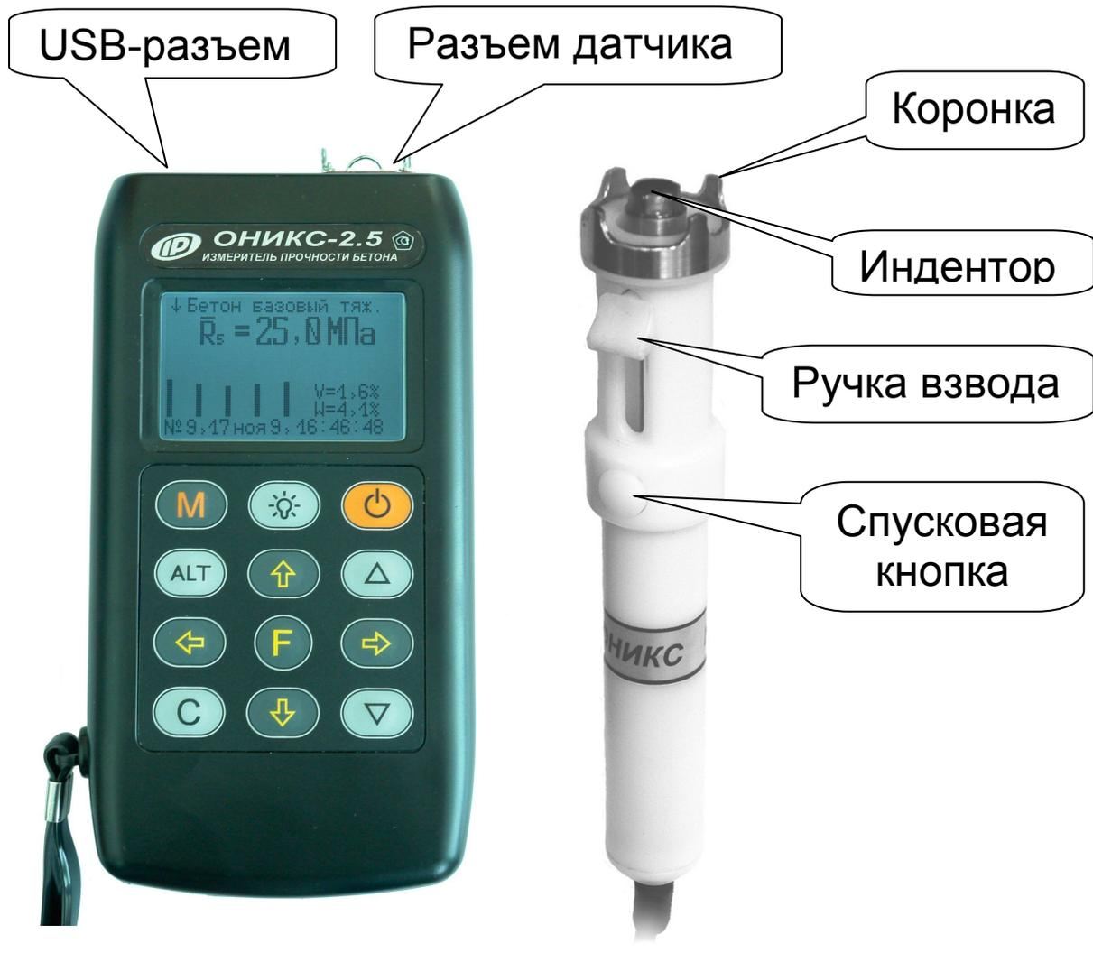
Рис. 3.1. Внешний вид прибора «Оникс-2.5»
