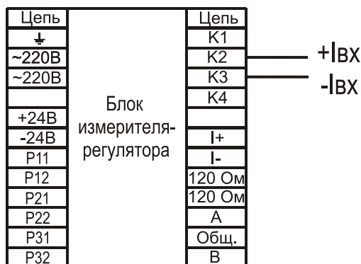
Рис.А5 Схема подключения входных клемм при измерении силы постоянного тока
