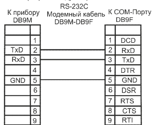
Рис.Б2б Схема кабеля RS-232C
