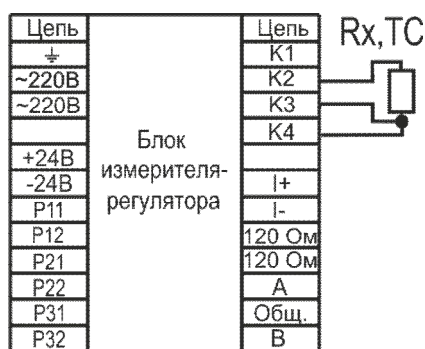
Рис.А2 Схема подключения входных клемм при измерении сопротивления (в том числе сигналов от термопреобразователей сопротивления) по трехпроводной схеме
