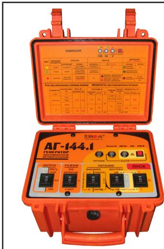
2. Включить генератор. Установить вид сигнала - прерывный «ПР»/ непрерывный «НП», частоту генерации на генераторе **512 Гц / 1024 Гц / 8192 Гц**
