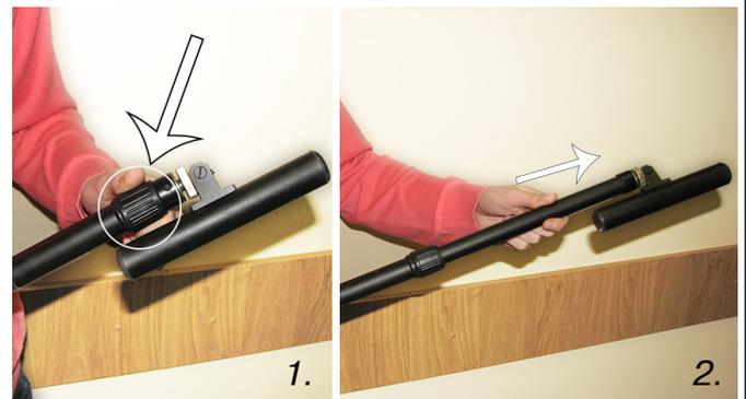
2.2 Ослабить фиксирующую гайку (1) и установить электромагнитную антенну (2) датчика в положение, используемое в трассопоиске. Зафиксировать положение фиксирующей гайкой. Горизонтальное положение – трассопоиск по методу максимума, транспортное положение – трассопоиск по методу минимума
