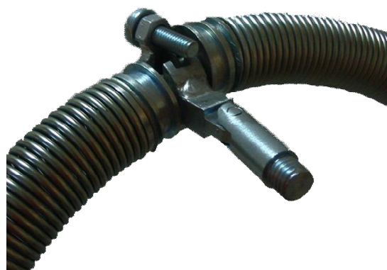
Рис. 22. Подготовленный к проведению контроля пружинный электрод
