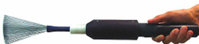
Рис. 20 Положение электрода, закрепленного в высоковольтном трансформаторе-держателе
