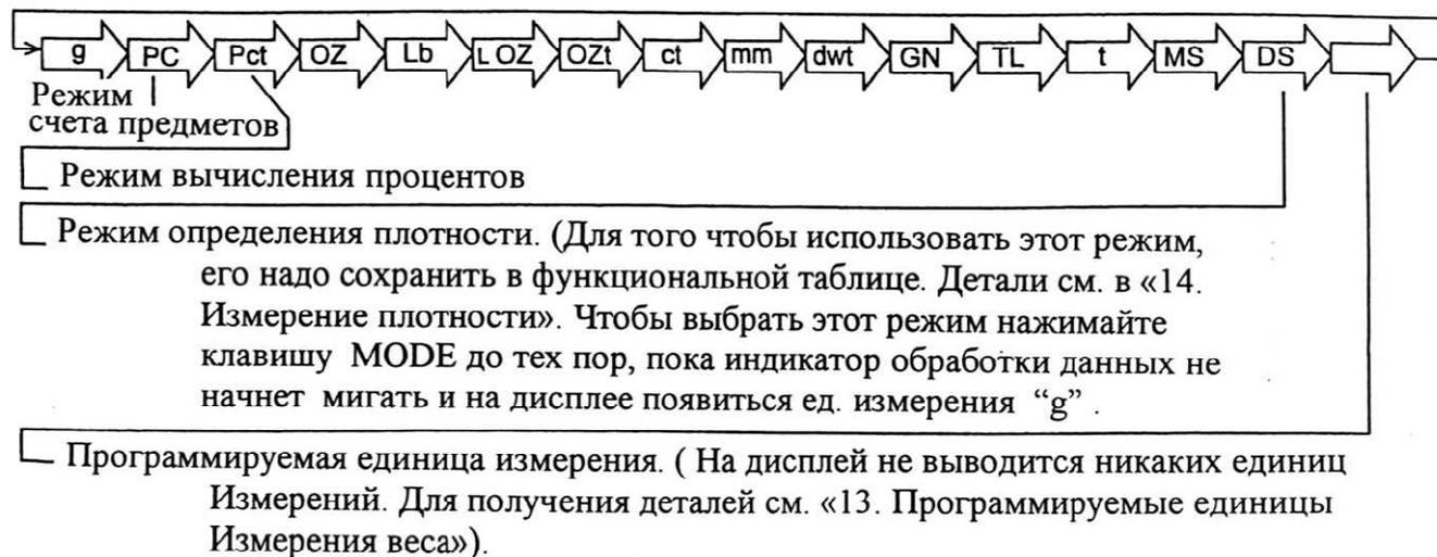
Единицы измерения или режим взвешивания могут быть выбраны и сохранены в таблице функций, как это описано на следующей странице. Если режим взвешивания (или единица измерения) был отключен, этот режим (единица измерения) будет исключен из списка. Для выбора единицы измерения или режима взвешивания нажмите клавишу **MODE**.
