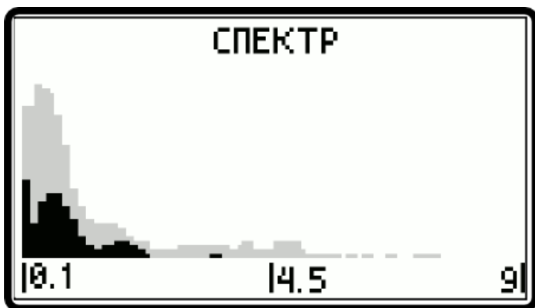
Рис. 6.5 Экран настройки спектра на бездефектном участке
