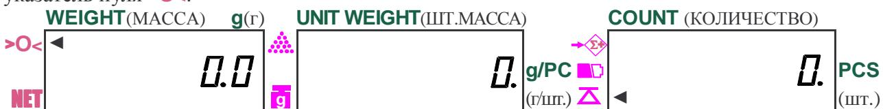
Если взвешиваемый груз имеет слишком малую массу, меньше 10 d, после его взвешивания на дисплее **UNIT WEIGHT** (ШТ.МАССА) включится указатель **▲**. На процедуре взвешивания это конкретно не сказывается, но в счетном режиме его включение информирует оператора, что дальнейшее измерение штучной массы приведет к слишком большой относительной ошибке в результате счета.
