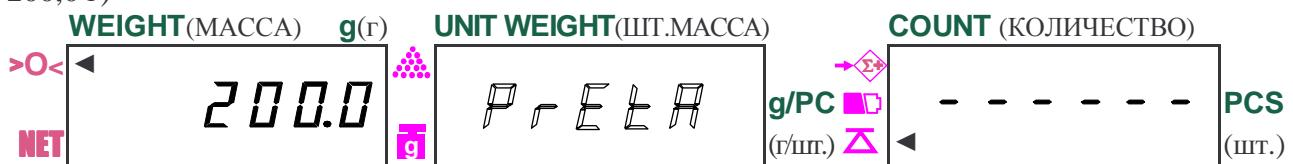
□ и нажмите клавишу **P.TARE**. На дисплее **WEIGHT** (МАССА) высветится введенная масса тары со знаком минус и включится указатель **NET**, а на дисплее **UNIT WEIGHT** (ШТ. МАССА) высветится нулевое показание.
