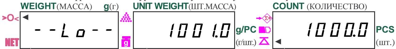
□ и нажмите клавишу **U.WT** или **ALARM**. Сначала проверяется, чтобы нижняя уставка была меньше верхней, и если они были введены правильно, на этом процедуре их ввода завершается, и установится режим дозирования (визуально он не отличается от режима взвешивания).
