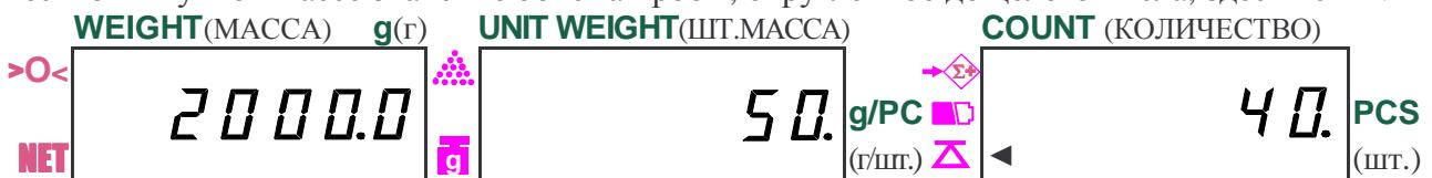
Итак, задержка при вводе объема пробы приводит к тому, что алгоритм работы весов устанавливается таким, как он изложен в п. 3.1. Чтобы все-таки счет выполнять для неизвестной штучной массы, необходимо обнулить показания на дисплеях **COUNT** (КОЛИЧЕСТВО) и **UNIT WEIGHT** (ШТ.МАССА), нажав клавишу **C**, а затем ввести объем заново.
