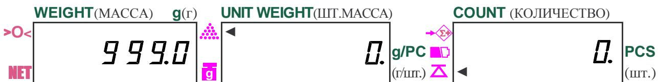
На дисплее **WEIGHT** (MACCA) высвечивается показание текущей массы дозы (здесь: 999,0 г), а на дисплее **UNIT WEIGHT** (ШТ. MACCA) включается указатель как результат
