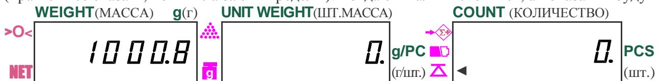
(мигание показания на дисплее **WEIGHT** (МАССА) прекратится). Доза готова и можно ее снимать с весов. Затем переходят к следующей фасовке.
