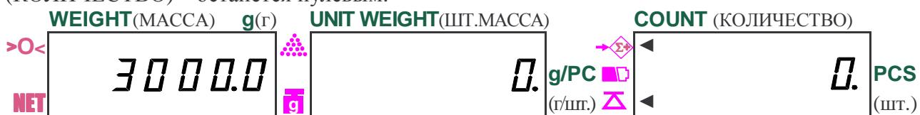
□ Уберите второй груз с платформы (показание на дисплее **WEIGHT** (МАССА) обнулится) и положите следующий взвешиваемый груз на платформу. Указатель нуля  $>0<$  выключится, а стабильности  $\Delta$  - сначала выключится, а затем включится вновь. На дисплее **WEIGHT** (МАССА) высветится показание массы груза (здесь: 5000,0 г).
