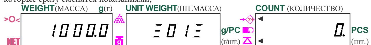
высвечиваемыми в течение ~ 3 сек (указатель суммирования →Σ будет включен). Здесь на дисплее UNIT WEIGHT (ШТ.МАССА) высвечивается порядковый номер взвешивания, а именно № 1. Затем показание на дисплее UNIT WEIGHT (ШТ.МАССА) обнулится, а на других дисплеях показания останутся прежними.
