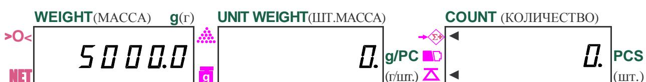
И так далее для всех грузов. В процессе суммирования или при его завершении имеется возможность проверить накопленную сумму. Например, после 3-го взвешивания, когда на дисплее **WEIGHT** (MACCA) высвечивается текущая масса (здесь: 5000,0 г) или груз снят, достаточно нажать клавишу **TOTAL**, и повторятся показания:
