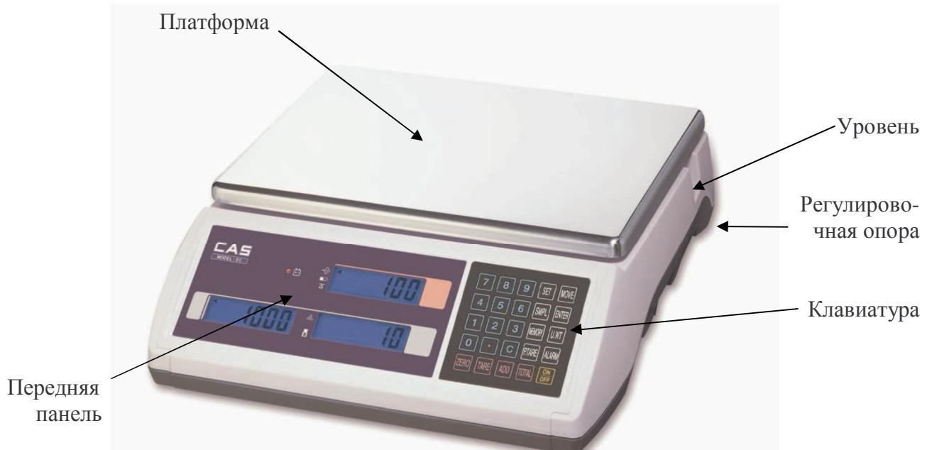
В днище весов с правой стороны имеется кнопка питания ВКЛ./ВЫКЛ. и гнездо для адаптерного штекера, а с левой стороны – интерфейсный разъем RS-232C; по центру днища расположен аккумуляторный отсек и перед ним – планка с 2 пломбировочными винтами, закрывающая доступ к юстировочной кнопке.
