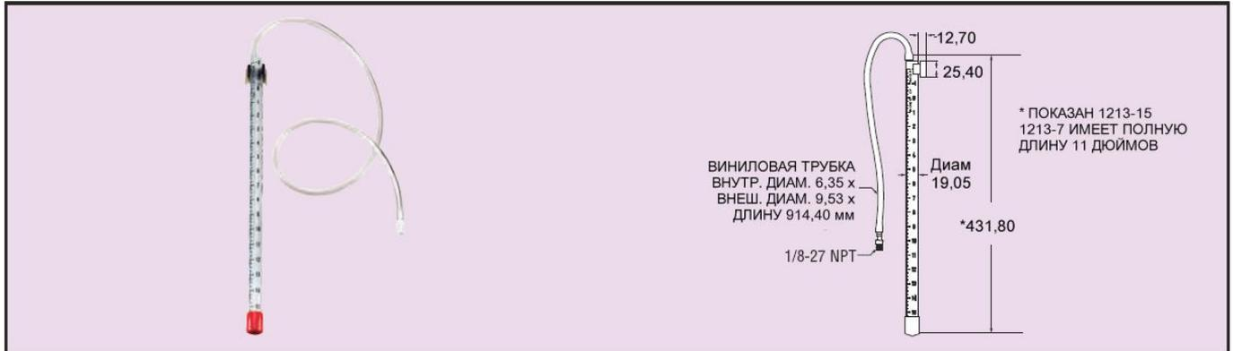
Обеспечивает визуальную индикацию давления с помощью Манометра давления газа серии 1213. Сконструированный для использования с природным газом манометр может быть также использован для мониторинга любых совместимых газов с давлением до 381мм. водяного столба. Экономичный по цене и сделанный из прочного пластика. В комплект включена 1 метровая виниловая трубка и нейлоновый переходник с внешней резьбой 1/8" NPT и штуцером на трубку.
