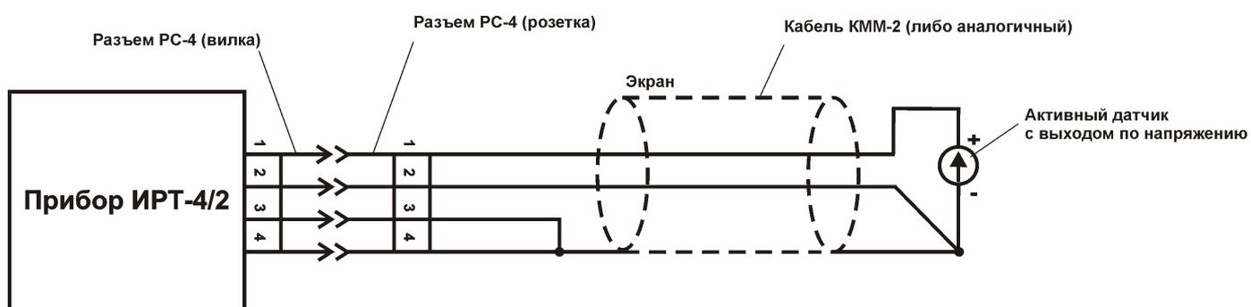
Рисунок 3.14 Схема подключения датчика с выходом по напряжению
