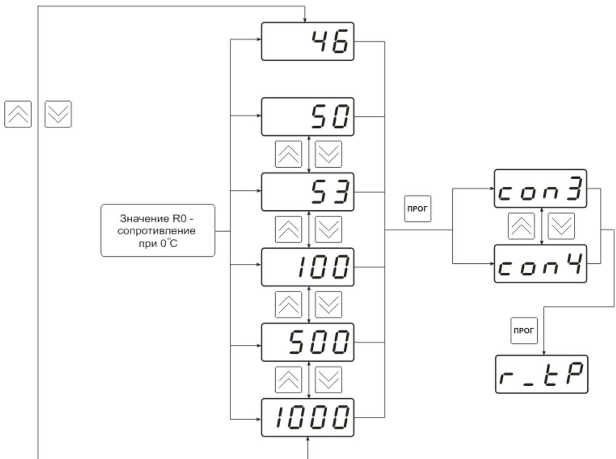
Рисунок 6.8 Установка значения R0 и выбор типа подключения
