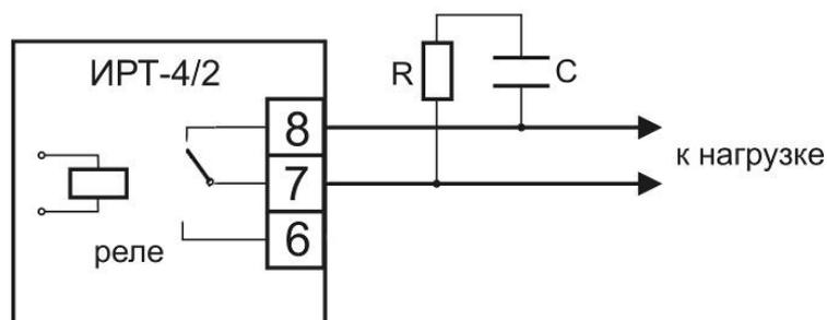
Рисунок 3.19 Подключение нагрузки к релейному выходу
