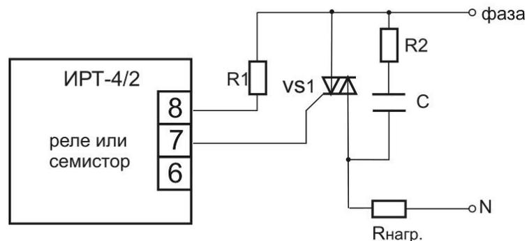
Рисунок 3.20 Схема подключения силового симистора
