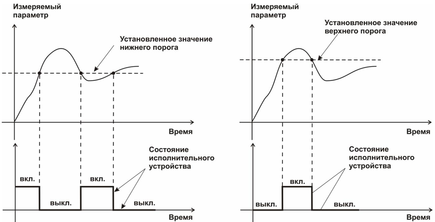
Рисунок 3.15 События: нарушения НП (слева), нарушение ВП (справа).
