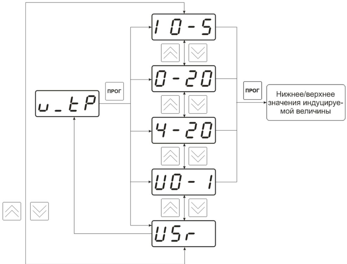
Рисунок 6.9 Выбор типа датчика с унифицированным сигналом
