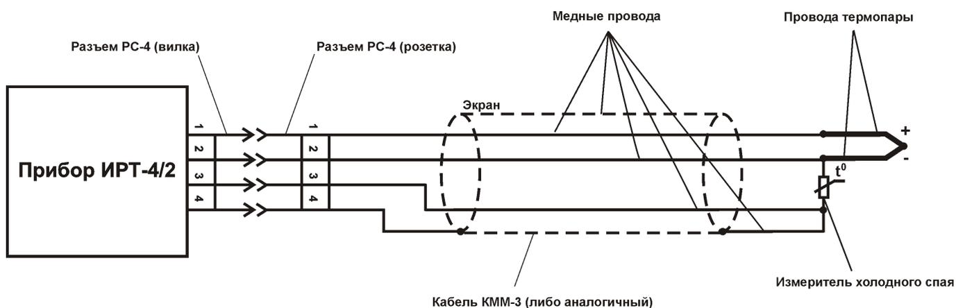
Рисунок 3.10 Схема подключения ТЭ преобразователей удлиненными медными проводами
