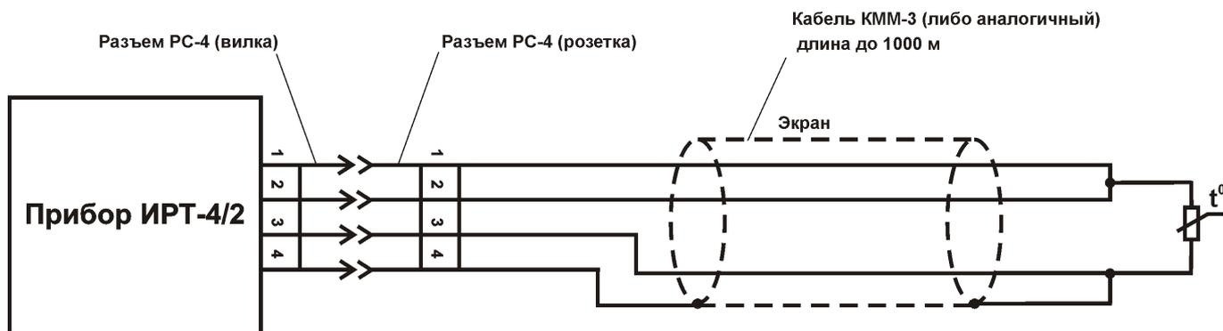
Рисунок 3.7 Четырехпроводная схема подключения
