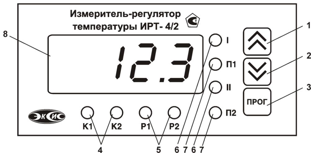
Рисунок 3.1 Передняя панель прибора
