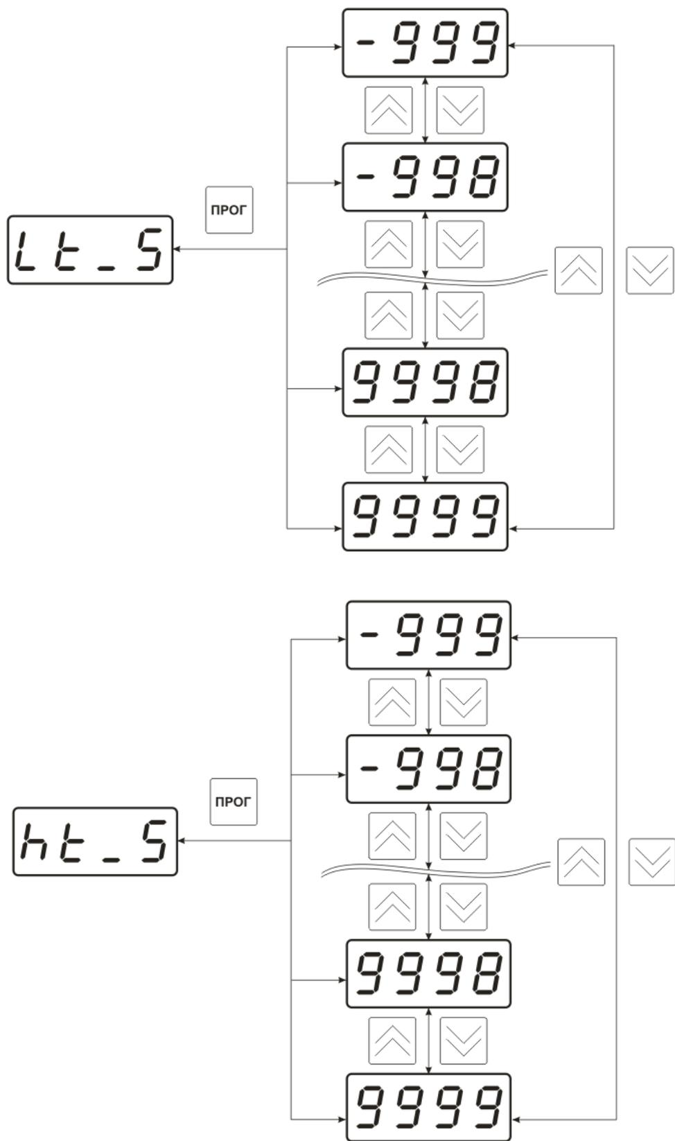
Рисунок 6.5 Установка пороговых значений для логического сигнализатора
