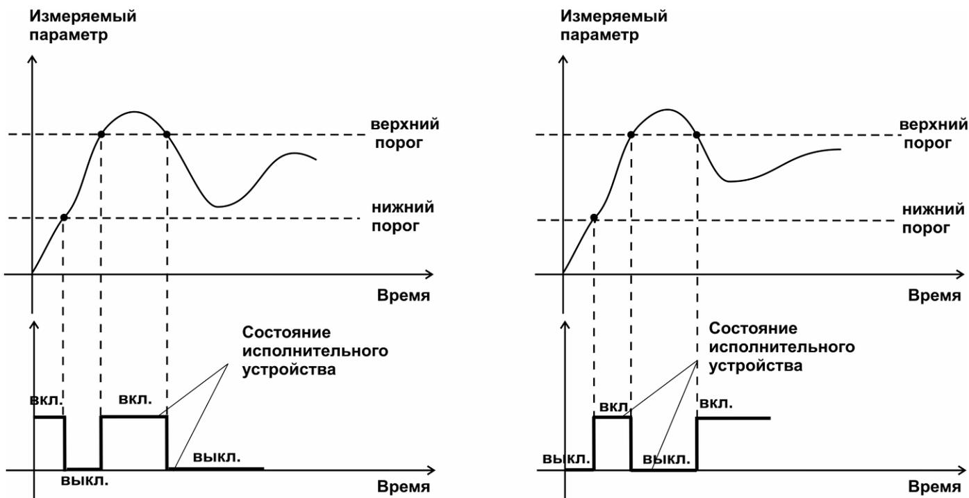
Рисунок 3.16 Функция вида  $f = \text{НП} + \text{ВП}$ , слева – сигнализация выхода измеряемого параметра за диапазон, справа – тоже с инверсией, сигнализация, что измеряемый параметр находится в диапазоне
