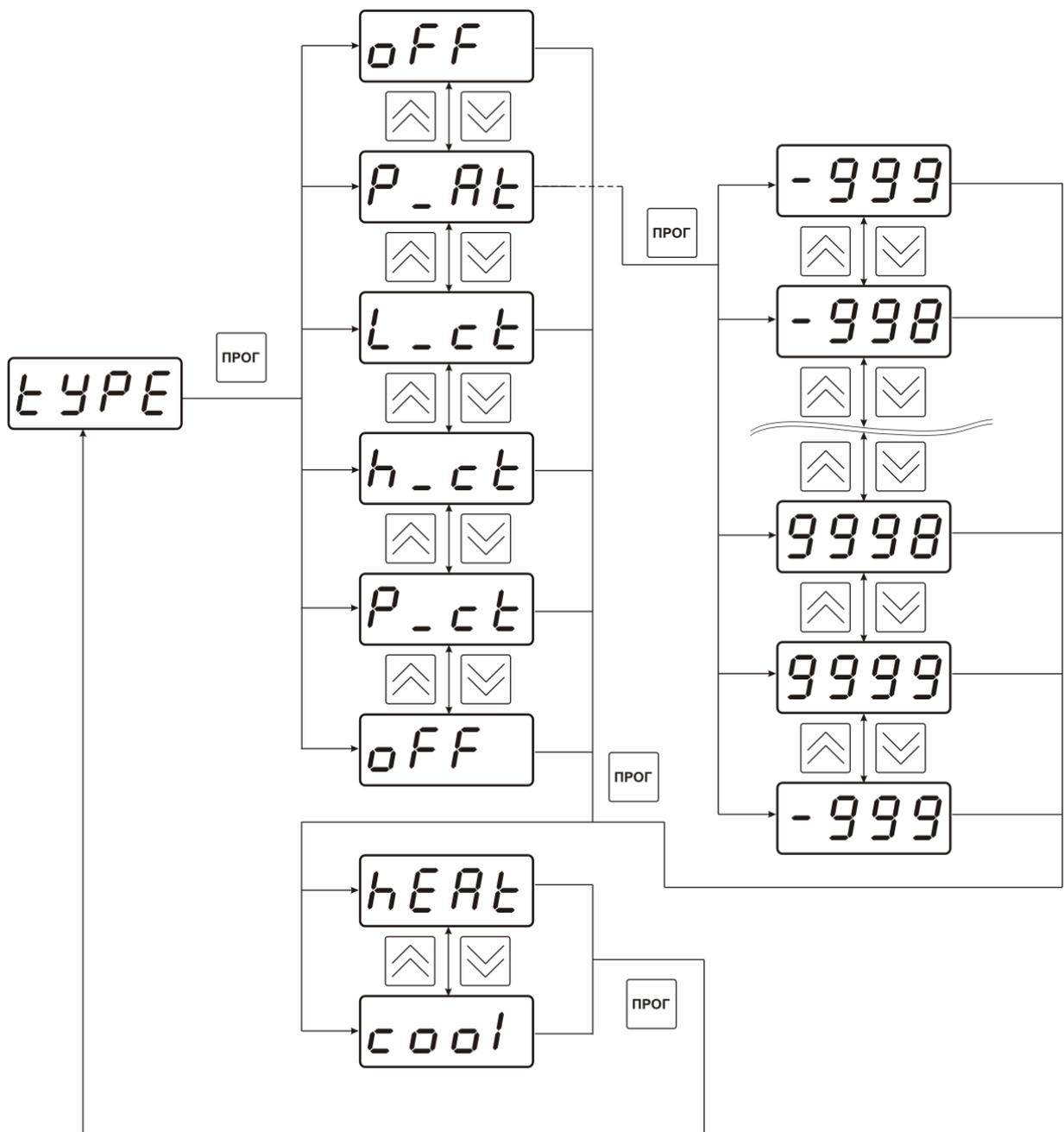
Рисунок 6.12 Логика и тип работы исполнительных устройств
