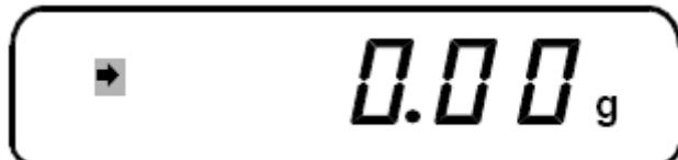
▫ Положите на платформу первый взвешиваемый груз. После стабилизации результат измерения высвечивается на дисплее и передается на печать (во время передачи на дисплее кратковременно высвечивается указатель ).
