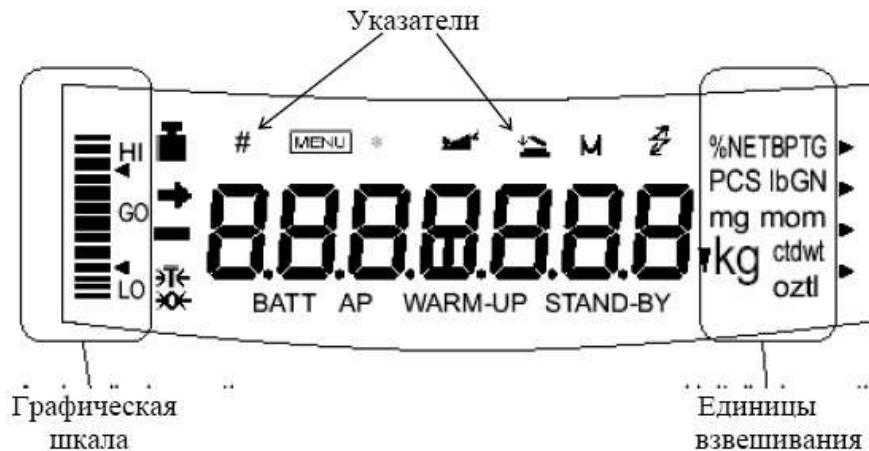
Указатели дисплея предназначены для обозначения состояния весов или функции, исполняемой в текущий момент:
