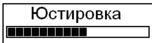
Во время индикации «Юстировка» проводится тестирование подключенного преобразователя. Во время тестирования необходимо удерживать преобразователь в воздухе на расстоянии не менее 400 мм от металлических изделий.
