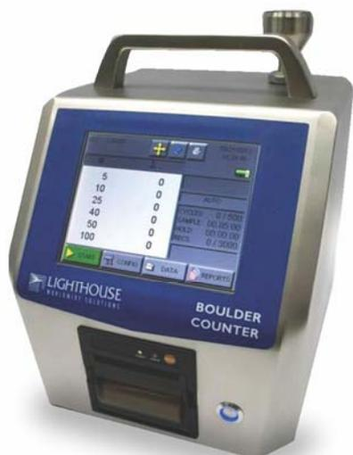
Solair Boulder Counter предназначен для измерения концентрации крупных аэрозолей – до 100 мкм. Портативные счётчики аэрозолей Solair Boulder Counter на 28,3 л/мин используют лазерный диод с повышенным сроком эксплуатации (срок до отказа более 20 лет, при круглосуточном использовании). Новая, облегчённая батарея и адаптер ещё больше повышают мобильность прибора. Интуитивно понятный интерфейс делает прибор одним из самых удобных и лёгких в обращении.
