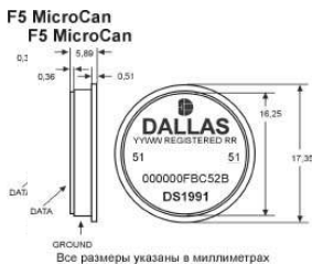
Ри-сунок 2 – Внешний вид и габаритные размеры измерителя–регистратора температуры DS1911.
