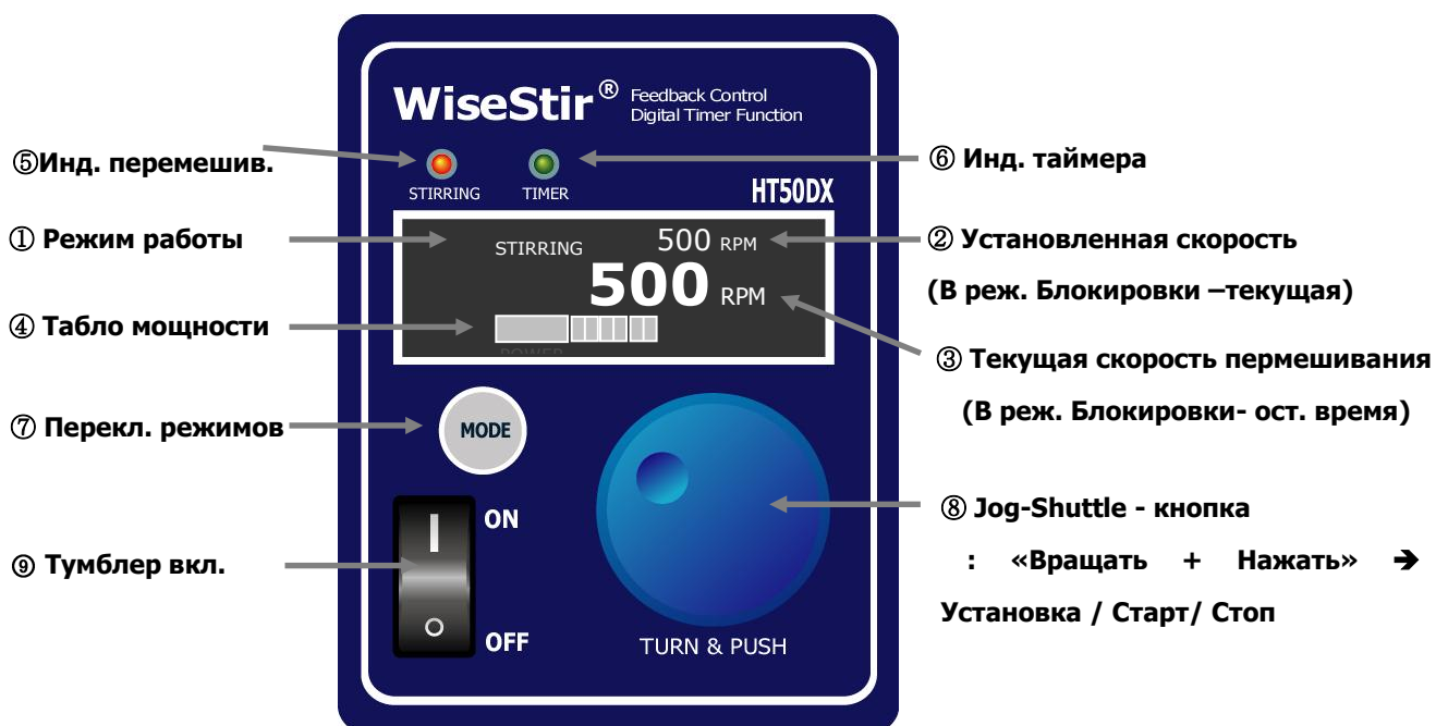
<Рис. 4> Панель управления высокомоощных моделей (HT-DX)
