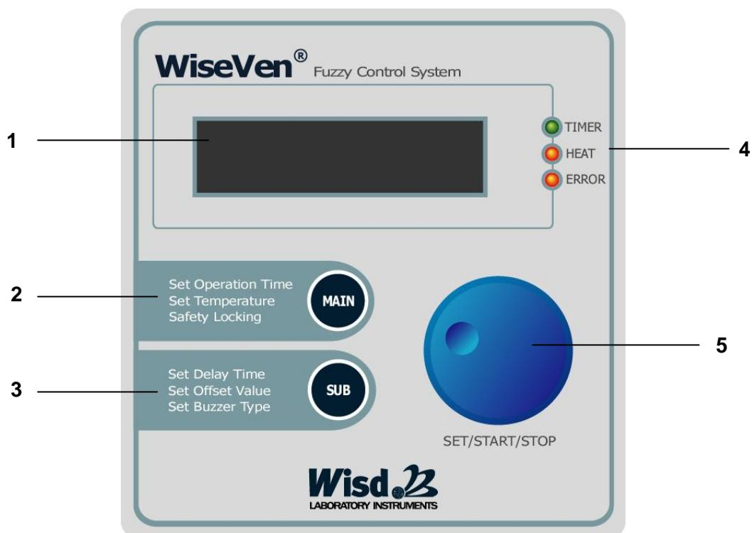
1 – ЖК-дисплей – отображается PV(Present Value) –текущая температура и SV(Set Value) –установленная температура и/или время.
