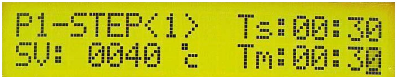
P1-Step – Программа 1 шаг 1, SV – заданное значение, Tm – время таймера, Ts – время, за которое произойдет нагрев до заданной температуры.
