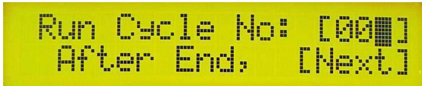
Вы можете установить от 1 до 999 циклов. Если вы хотите, чтобы программа повторялась до отмены нажатием кнопки Старт\Стоп (13), установите значение циклов на 000.
