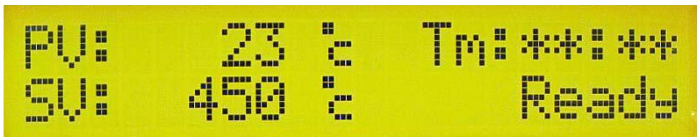
После включения прибора дисплей покажет данные текущего статуса. Если прибор был выключен в связи с экстренным отключением электричества, он покажет последние данные перед выключением.
