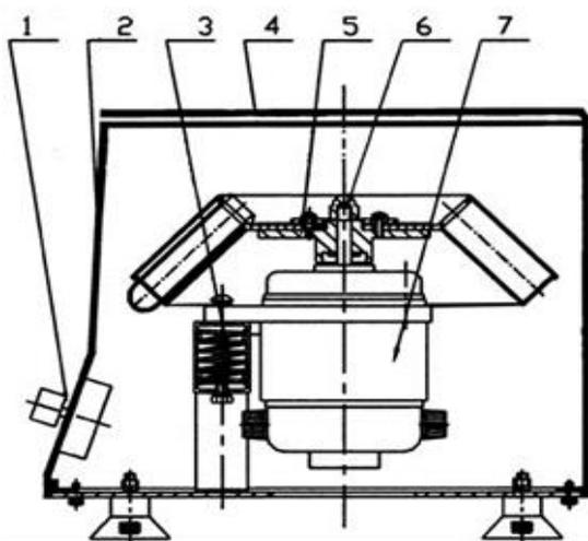
1. Панель управления; 2. Корпус; 3. Демпфер; 4. Крышка; 5. Ротор; 6. Гайка; 7. Двигатель
