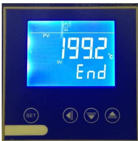
После окончания времени работы прибор прекратит нагрев и в течении 1 минуты будет издавать короткие звуковые сигналы с интервалом в несколько секунд. В разделе дисплея «PV» будет отражаться остаточная температура на нагревательной поверхности, а в разделе дисплея «SV» будет гореть надпись «End». Для начала нового цикла нагрева нужно выключить и включить прибор заново при помощи кнопки включения/выключения.
