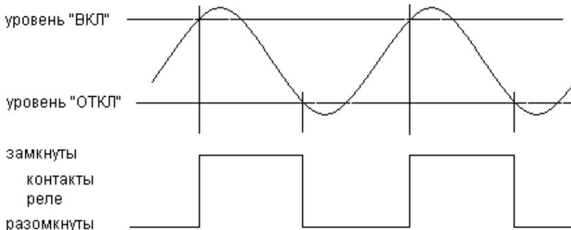
В режиме 2 контакты реле замыкаются при уровне меньше значения "ВКЛ" и размыкаются при уровне больше значения "ОТКЛ".
