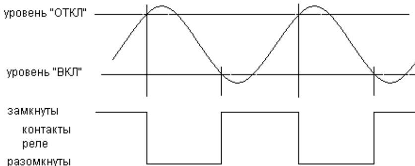
Режим работы выбирается автоматически при установке уровней "ВКЛ" и "ОТКЛ": если уровень "ВКЛ" больше уровня "ОТКЛ", то выбран 1, если уровень "ВКЛ" меньше уровня "ОТКЛ", то выбран 2. Контакты реле уставок выведены на одноименные клеммники: уставка "В" на клеммник "В", уставка "Н" на клеммник "Н" и уставка "С" на клеммник "С".
