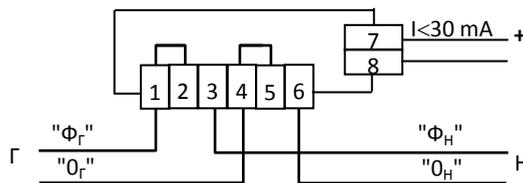
**Примечание:** Номинальное напряжение, подаваемое на телеметрический выход (конт. 7 и 8), равно 12 В (предельное 24 В). Номинальная сила тока для этого выхода – 10 мА (предельная – 30 мА).
