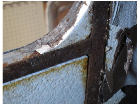
Изоляция и металлическая рамка жилого автофургона старой модели
