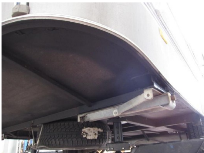
Днище жилого автофургона: массивная древесностружечная плита, с небольшой защитой
