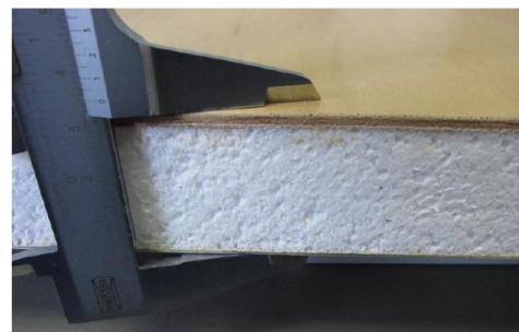
Пример многослойной конструкции: алюминий-изоляция-фанера
