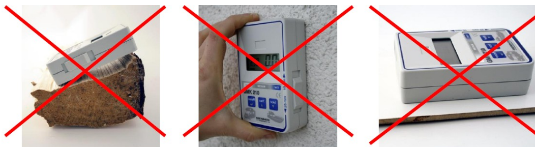
Неправильно: складчатая поверхность (экстремальный пример)
