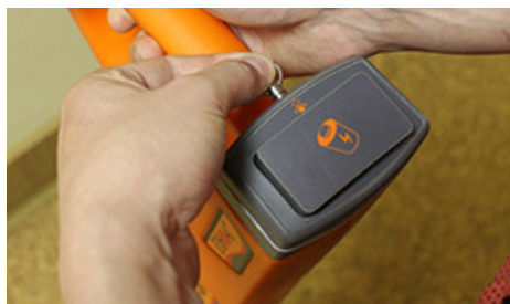
а) Потянуть за фиксатор и освободить батарейный отсек
