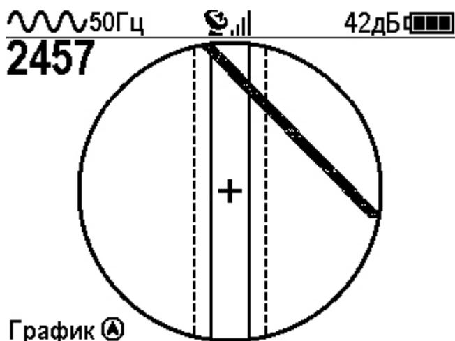
Режим «График» - на индикаторе дополнительно с положением трассы отображается график изменения уровня сигнала на рабочей частоте.
