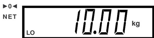
□ Нажмите клавишу **ZERO** для перехода к режиму установки нижнего предела дозирования. На дисплее высветится предлагаемый нижний предел дозирования, причем один разряд будет мигающим. Это означает то, что его можно изменить. Мигающий знак <\_> эквивалентен нулю. Для изменения мигающего разряда используйте клавишу **MODE**. Затем, для перехода к изменению следующего разряда, нажмите клавишу **TARE**. Ниже приведен пример ввода нижнего предела.
