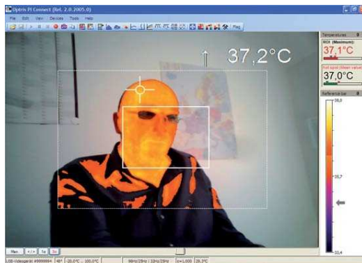
Наложение изображения видимого света при температурах выше 35 °C
