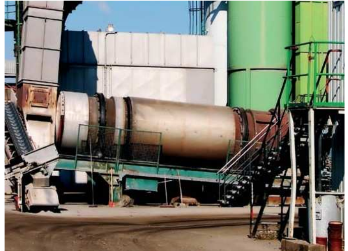
Пример применения: Вращающаяся печь в химической промышленности
