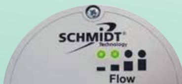
LED индикация позволяет определить уровень расхода по четырем LED сигналам и проверить работоспособность прибора. В случае поломки устройства зеленая индикация сменяется миганием красного цвета. Расходомер имеет возможность выводить аналоговый сигнал как в 0...10В, так и в 4...20 mA, автоматически определяя сигнал по схеме подключения.
