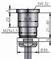
Для монтажа на панели толщиной от 21 до 40 мм, особенно для пустых потолочных перегородок. Требуется отверстие диаметром 26 мм и 28,5 мм.
