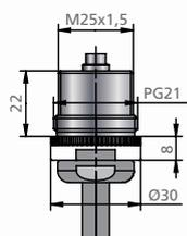
Для монтажа на отверстие с резьбой PG21 (напр. отверстие спринклера) в раме.
