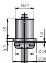
Для приварки к потолку или стенам из нержавеющей стали. Для герметичного монтажа.
