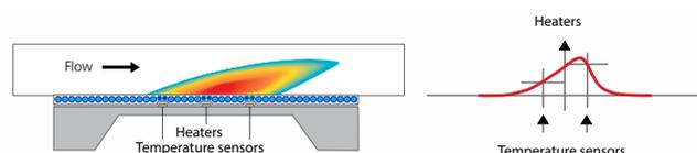
Над нагревающим элементом формируется область теплого воздуха, сдвигаемая потоком. Слева и справа от нагревающего элемента находятся датчики, измеряющие температуру среды. Из расчета разницы в результатах этих измерений определяется скорость потока, приведенная к стандартным условиям. Кроме этого, область, в которой температура воздуха выше, указывает на направление потока (доступно в качестве опции).
