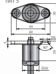
Для установки с помощью двух М6-винтов под потолком или на стену. Необходимы отверстия в потолке/стене диаметром 15 мм для кабеля и 2 М6 для винтов.
