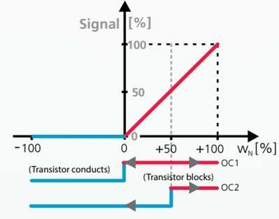
Замечание: В случае однонаправленного исполнения, релейный выход OC1 используется для индикации наличия потока. Он будет замыкаться при скорости потока выше 0 м/с, и размыкаться, когда значение будет равно 0 м/с или опустится ниже. Стрелки на изображениях означают, что пороговые значения могут быть перенастроены. Заводские настройки для релейного выхода OC2 – 50% измерительного диапазона (опция: точка переключения, задаваемая пользователем).
