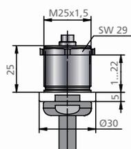
Для крепления к потолку, стенам и панели, толщиной от 1 до 22 мм. Требуется отверстие в потолке диаметром 26 мм для стопорной гайки или резьбы.
