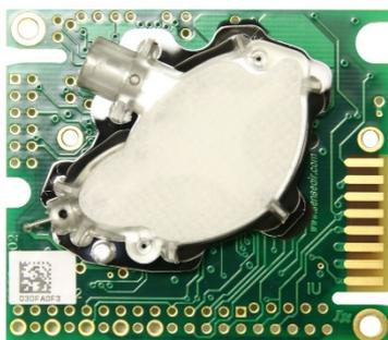
Сенсор концентрации CO<sub>2</sub> K30 создан для различных применений в сфере измерения и контроля. Он спроектирован как OEM-модуль для встраивания в измерительные приборы. K30 – универсальный продукт с двумя аналоговыми и двумя цифровыми выходами, которые могут быть настроены при помощи SADK или другого программного обеспечения.
