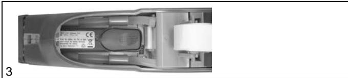
5. Выньте аккумуляторную батарею из прибора и вставьте новую батарею. Используйте только аккумуляторную батарею Testo 0515 0107!
