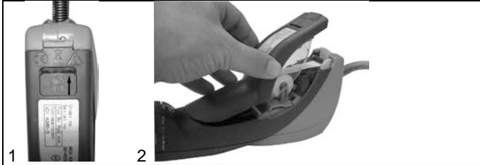
4. Откройте затвор батареи, нажав серую кнопку и одновременно сдвигая затвор в направлении стрелки (3).
