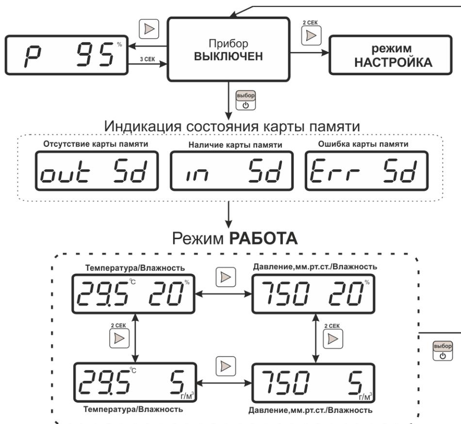
Рисунок 5.4 Режим **РАБОТА** ИВТМ-7 М 6-Д с каналом измерения атмосферного давления
