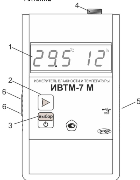
Рисунок 3.3 Внешний вид измерительного блока ИВТМ-7 М 3(-Д)
