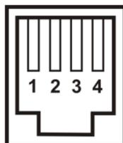
Рисунок 3.4 Цоколевка разъема подключения к сети RS-485
