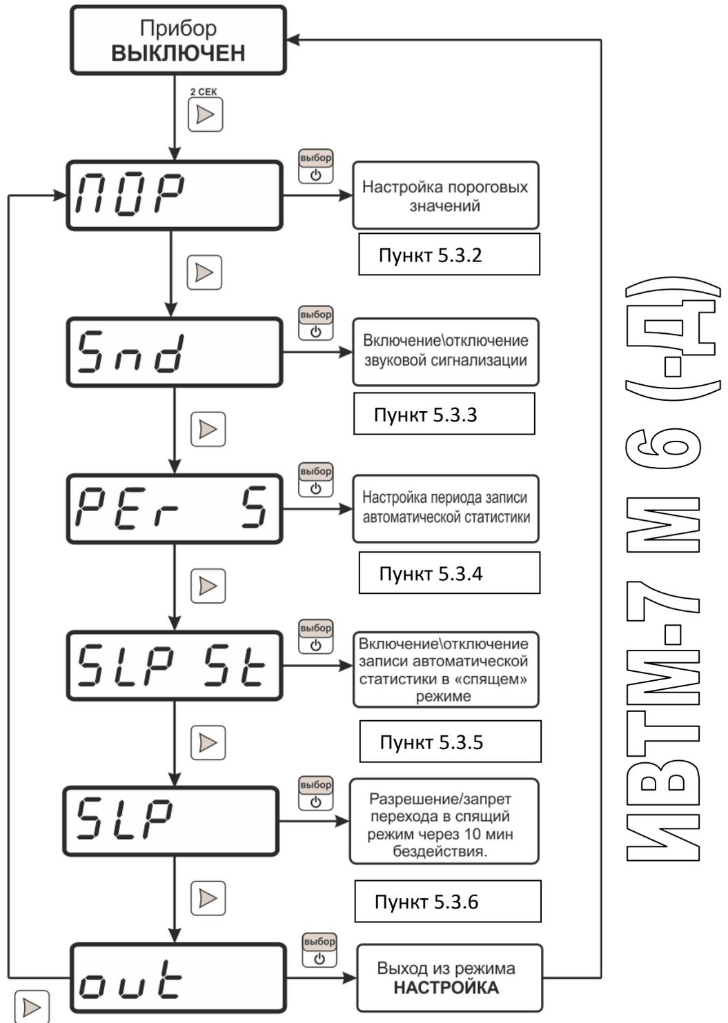
Рисунок 5.9 Схема режима **НАСТРОЙКА** ИВТМ-7 М 6(-Д)
