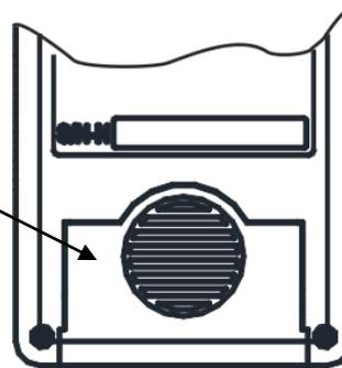
Емкость аккумуляторов составляет 1800 мА/ч, Зарядка осуществляется через разъем USB на боковой панели прибора. Для зарядки следует использовать зарядное устройство, обеспечивающее напряжение 5В с током зарядки не менее 1 А. Средний ресурс аккумулятора 500 циклов заряда-разряда.
