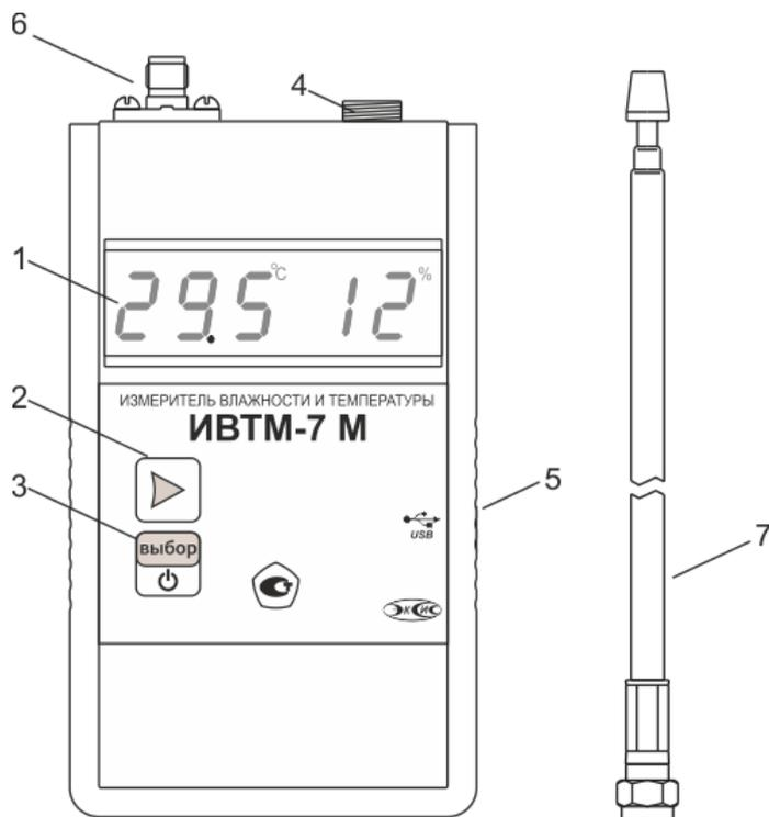
Рисунок 3.2 Внешний вид измерительного блока ИВТМ-7 М 4(-Д)
