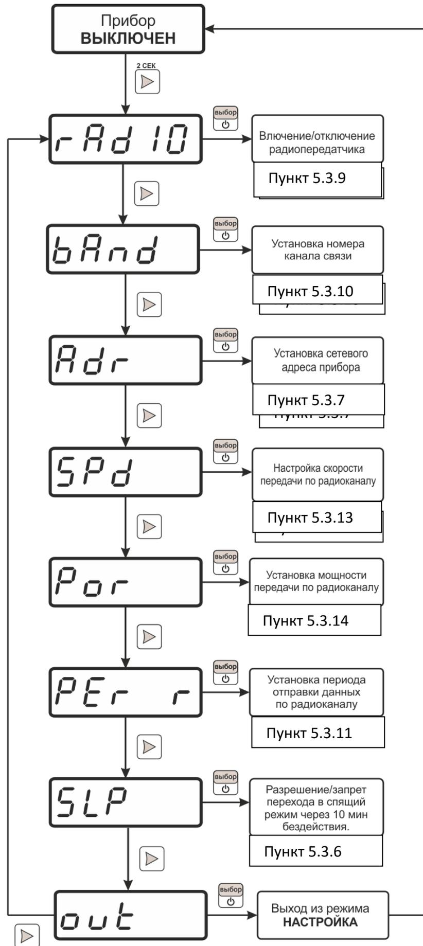
Рисунок 5.8 Схема режима **НАСТРОЙКА** ИВТМ-7 М 4(-Д)
