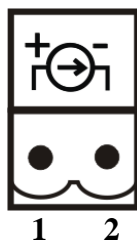
Рисунок 3.4 Разъем токового выхода 1 – токовый сигнал 2 – общий (земля)
