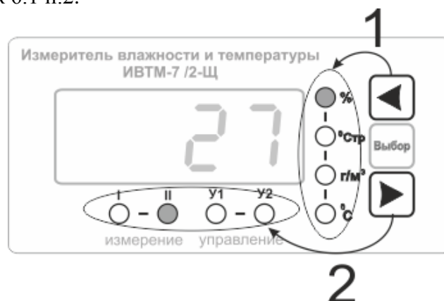
Рисунок 6.1 Схема функциональное назначение кнопок управления
